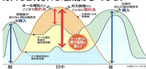
「太陽光発電」の利用で、基本的には朝晩は電力会社から"買う"電気、日中は自家発電の電気でまかない、余った分が"売る"電気となります。当然ですが、「オール電化」は、「ガス併用」の場合より"売る"電気が少なくなります。
